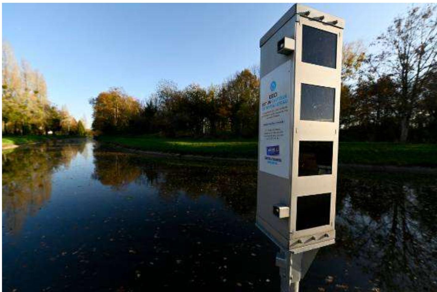
Capteur de niveau d'eau sur le canal à Fay-aux-Loges : il en existe 6 autres le long du canal entre Combreux et Orléans. ©
