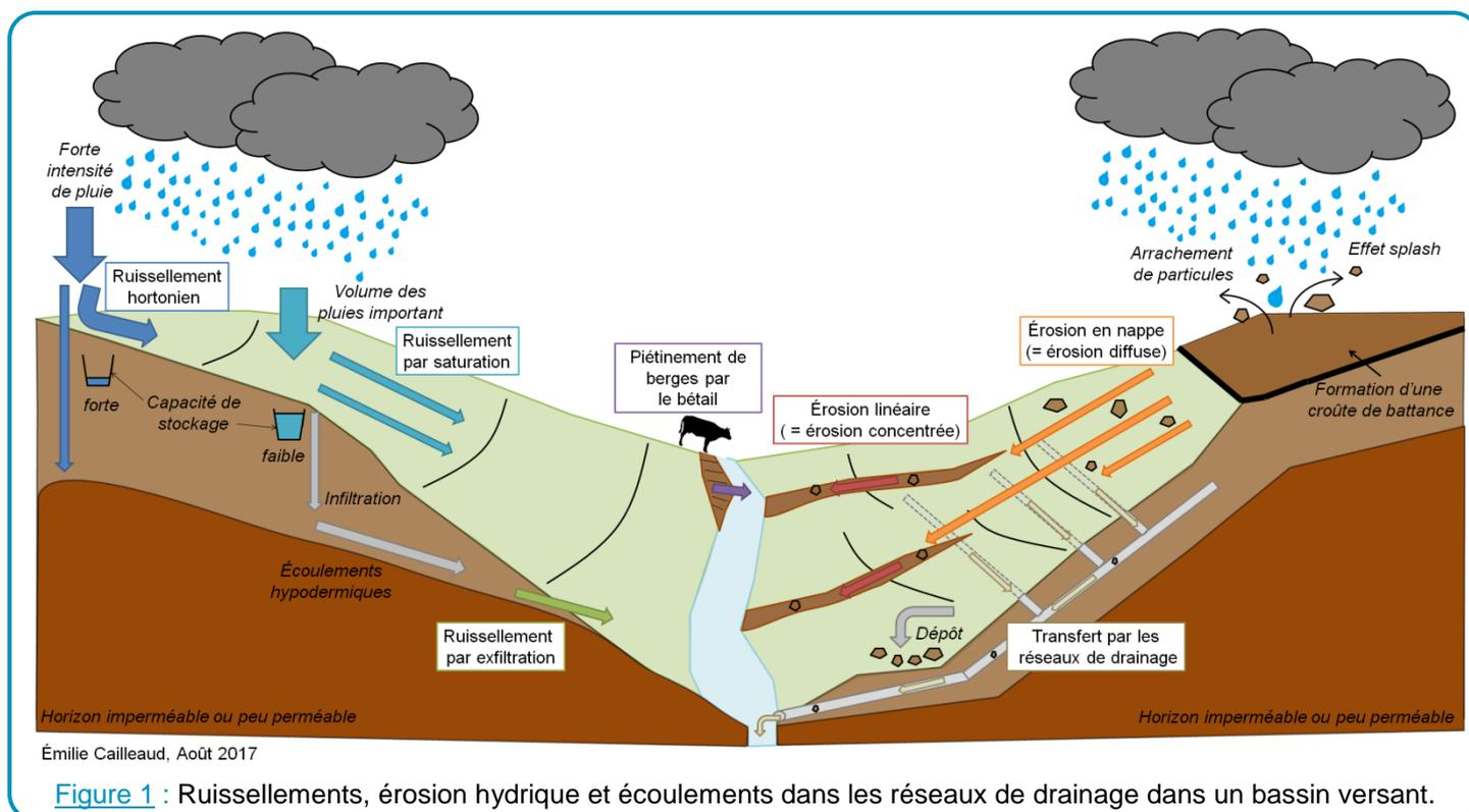
Figure 1 : Ruissellements, érosion hydrique et écoulements dans les réseaux de drainage dans un bassin versant.
